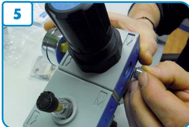
5. Gegenüberliegendes Gewinde mittels Gewindeblindstopfen verschließen.
